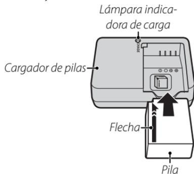
La cámara utiliza una pila recargable NP-W126.
