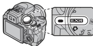
**P, S, A, M:** Seleccione estas posiciones para tener el control total de los ajustes de la cámara, incluida la apertura (**M** y **A**) y/o la velocidad de obturación (**M** y **S**) (p. 32).
